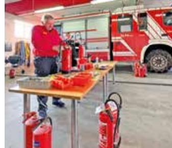
Im Februar fand für die Bevölkerung von Wies eine Feuerlöscherüberprüfung in Zusammenarbeit mit der Firma Noris statt. Handfeuerlöscher müssen alle zwei Jahre einer Überprüfung unterzogen werden.
